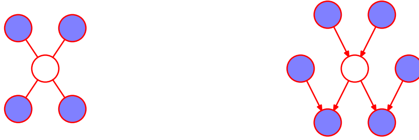
图 11.12: 吉布斯采样方法要求样本从一个变量的条件概率分布中抽取, 条件是其他的变量。对于图模型来说, 条件概率分布只是马尔科夫毯中的结点状态的函数。对于无向图来说, 马尔科夫毯由相邻结点的集合组成, 如左图所示。而对于有向图来说, 马尔科夫毯由父结点、子结点、同父结点组成, 如右图所示。
