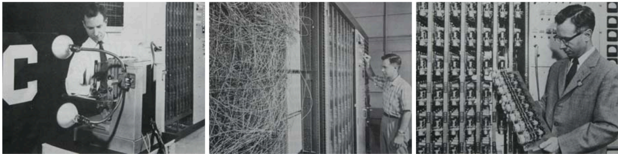
图 4.8: Mark 1 感知器硬件。左图展示了输入是如何使用一个照相机得到的, 其中输入空间, 在这种情形下是一个印刷的汉字, 被强光照射, 从而一张图像被集中到了一个 20 \times 20 的硫化镉光电管的阵列上, 形成了一个原始的 400 像素图像。感知器也有一个接线板, 如中图所示。它使得机器可以尝试输入特征的不同配置。通常这些线被随机连接, 展示了感知器的学习能力不需要精确的接线, 这与现代数字计算机不同。右图的照片展示了一个可调节权值的支架。每个权值使用一个滑动变阻器实现, 这个滑动变阻器也被称为分压器。它被一个电动机驱动, 因此使得权值可以通过学习算法自动被调节。
